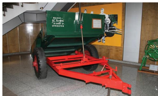
Obr. 2 Úplne prvá vlečka s mechanickým vyklápaním
